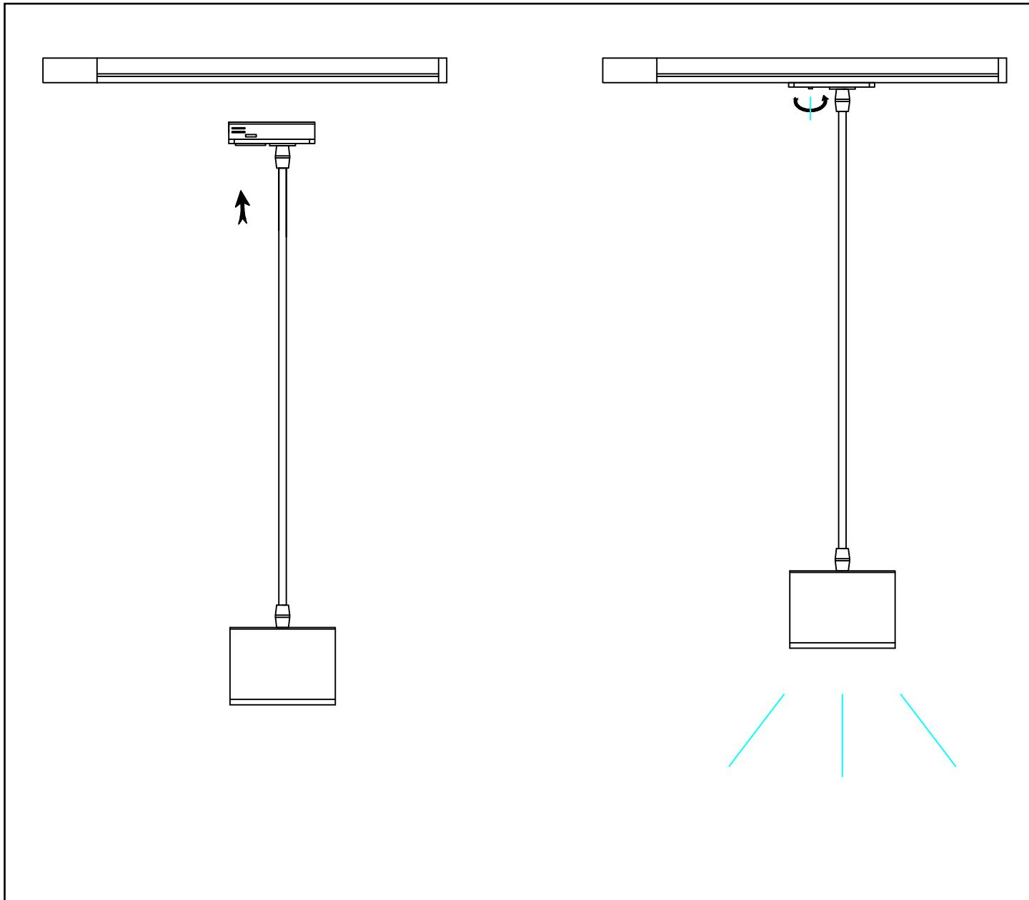
**ВНИМАНИЕ.** Все работы по монтажу шинопровода и установке светильников, замене ламп и техническому обслуживанию следует проводить при отключенном напряжении питания шинопровода. Категорически запрещается производить перемещение светильников вдоль шинопровода во включенном состоянии.
